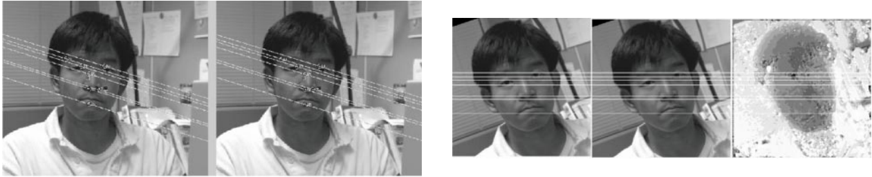
図3 2枚の画像(左2枚)を仮想画像面に変換(中央2枚)し、視差画像(右)を求める
