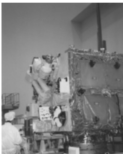
写真1 衛星に搭載された高機能ロボットハンドシステム(中央下)
