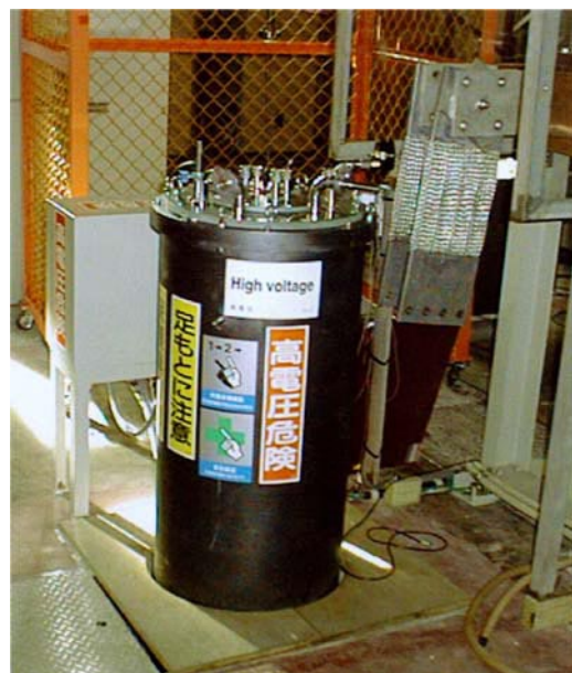
図2 . 1.2MVA 交流超電導マグネット
