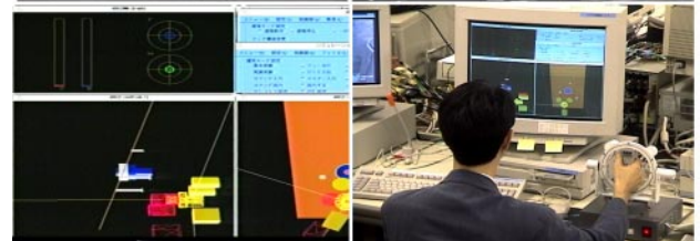
操作後 (左上: リールに掛け替えられたワイヤ、右上: ハンド、左下: グラフィックシミュレータ、右下: 操作卓)
