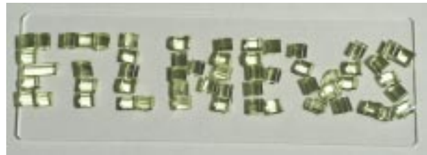
写真1 今回開発された薄膜作製法により色素層を形成したポリカーボネートペレットの光異性化反応：紫外光照射後（左） 近赤外光照射後（右）
