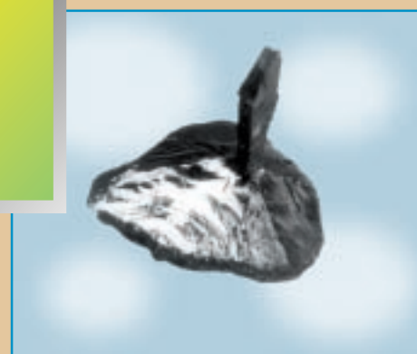
引き上げ法により成長した \text{La}_2\text{CuO}_4 系単結晶
