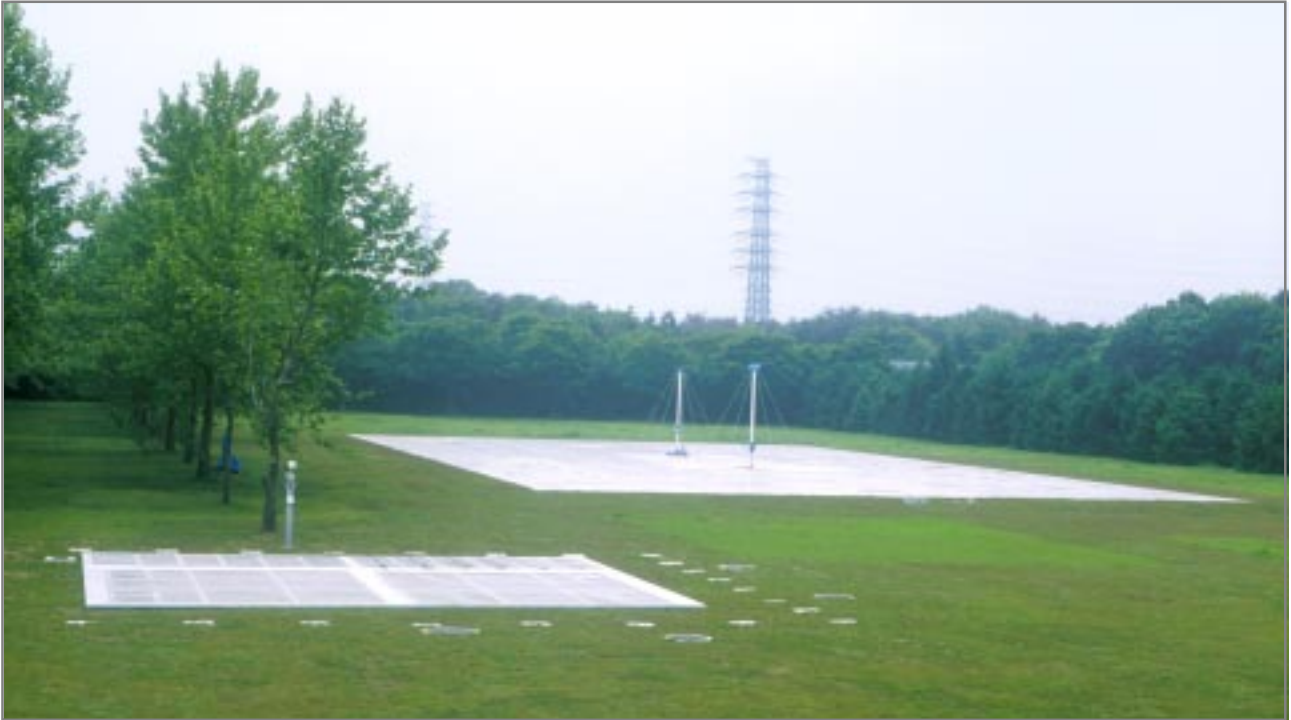
写真 標準アンテナ測定用オープンサイト
