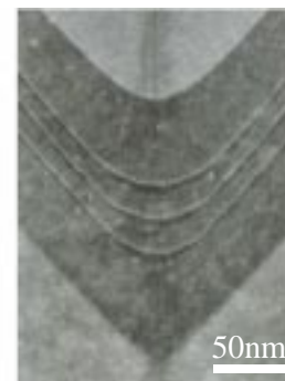
図1 3重量子細線レーザーの模式図(左)、SEM断面写真(中)、TEM断面写真(右)
