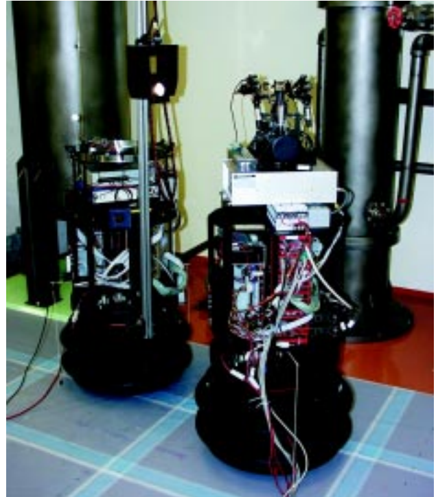
写真3 プラント点検システム
