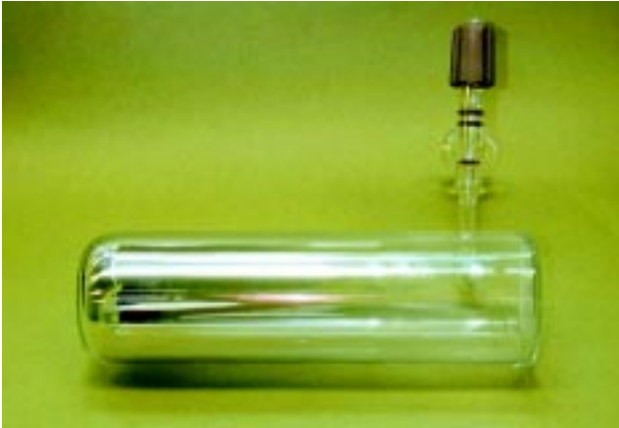
写真1 Rb金属を蒸着した後、Xeガスを封入したコックつき偏極用パッチ
