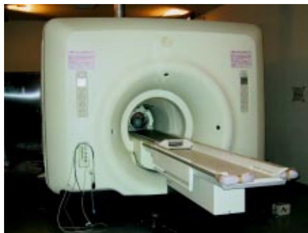
写真1 3テスラ超高磁場磁気共鳴装置 脳活動の検出感度が高い新鋭機
