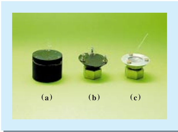
図2 3種類の受圧板 (a) ゴム製平面型 (b) ゴム製円錐型 (c) アルミ製円錐型
