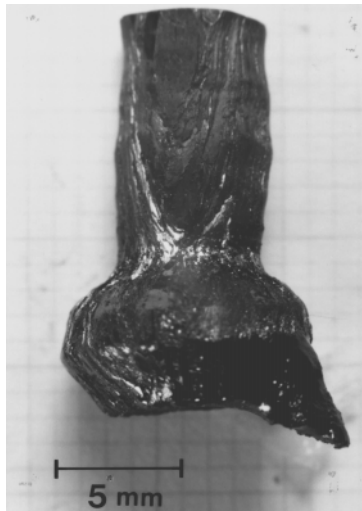
図16 TSSG法により育成したBi 2 Sr 2 CaCu 2 O 8-y の単結晶
