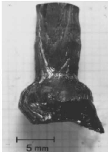
図16 TSSG法により育成した \text{Bi}_2\text{Sr}_2\text{CaCu}_2\text{O}_{8-y} の単結晶
