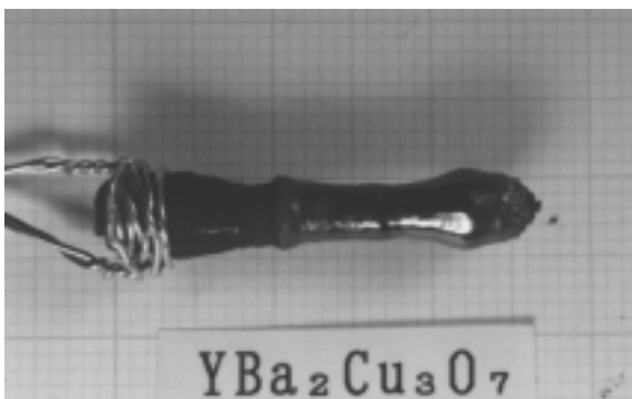
図14 TSFZ法により育成したYBa 2 Cu 3 O 7 単結晶
