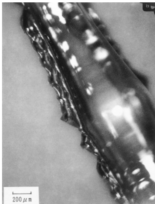
図3 LN単結晶ファイバーの成長稜 c軸ファイバー，速度200 μm/minで軸上方へ育成
