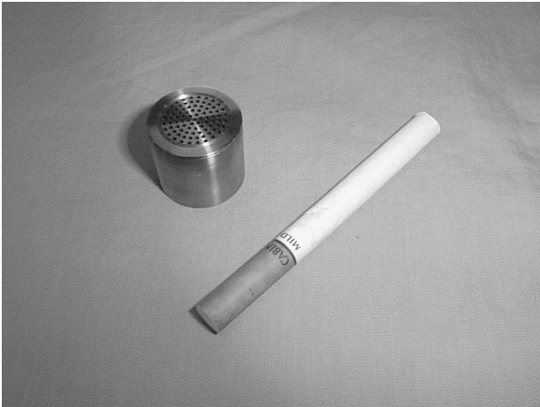
Fig.2 試作したI形マイクロホン
