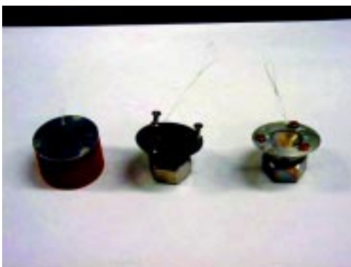
Fig.2 受圧板写真 ゴム製平面型(B)(左), ゴム製円錐型(C)(中), アルミ製円錐型(A)(右)
